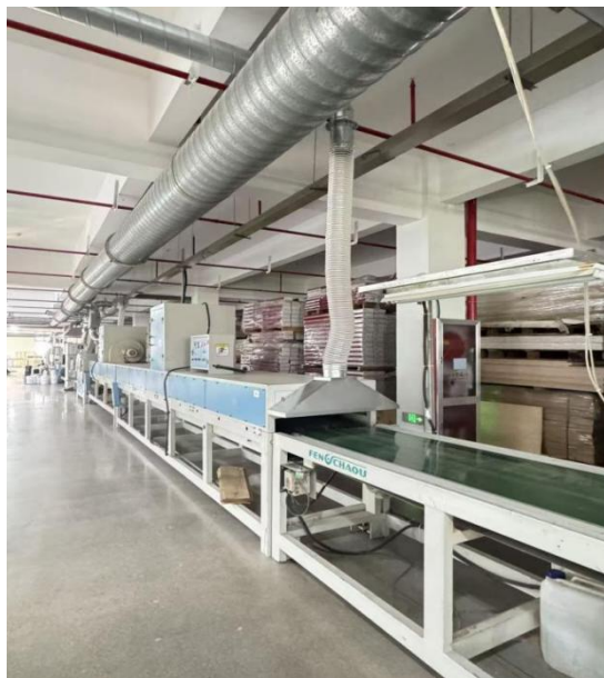
图 3-3 油漆线废气收集实拍图
