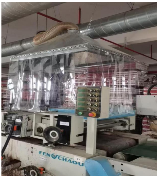
图 3-3 油漆线废气收集实拍图
