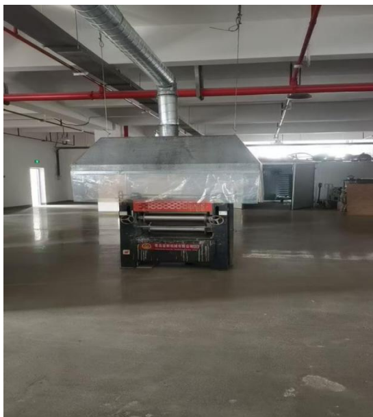
图 3-4 涂胶机收集实拍图
